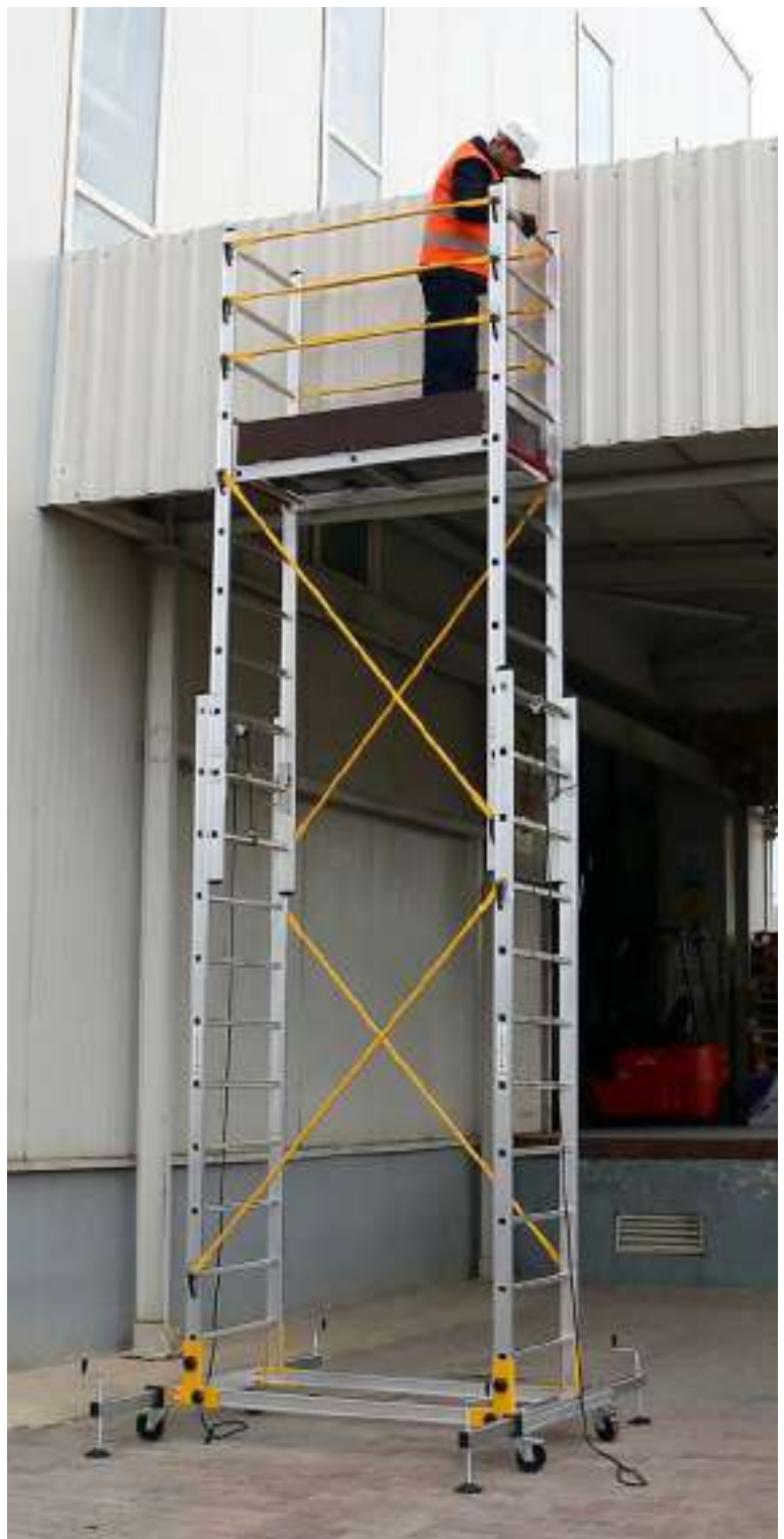
Base provista de estabilizadores extraíbles y husillos regulables para salvar hasta 26 cm de desniveles
